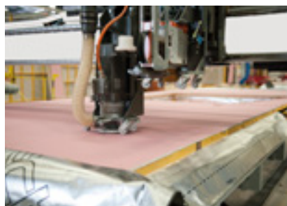
Lavorazione del cartongesso
