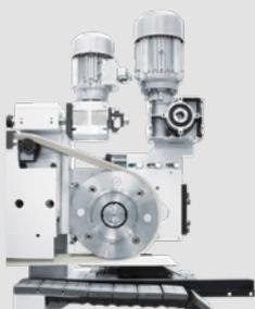
**Pressore superiore motorizzato**
