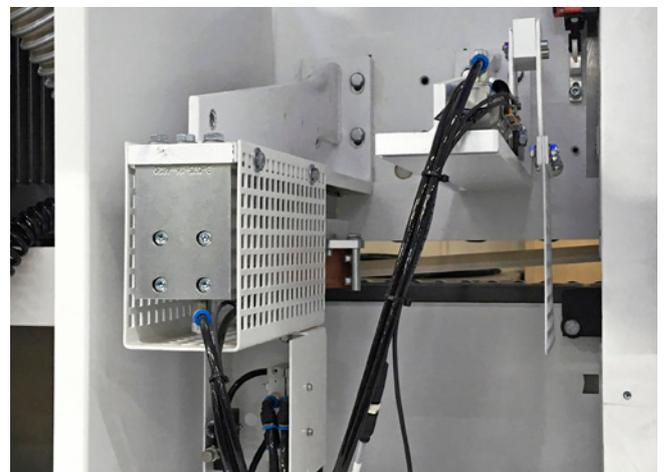
**Предохранительное прижимное устройство**
