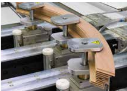
Élément de serrage à 3 niveaux : éléments de serrage rigides à 3 niveaux avec une hauteur de serrage importante pour l'usinage complet précis de pièces de fenêtres et de portes sans détournement ultérieur
