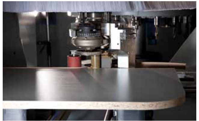
Agrégat d'encollage easyEdge pour un encollage rationnel des pièces de forme
