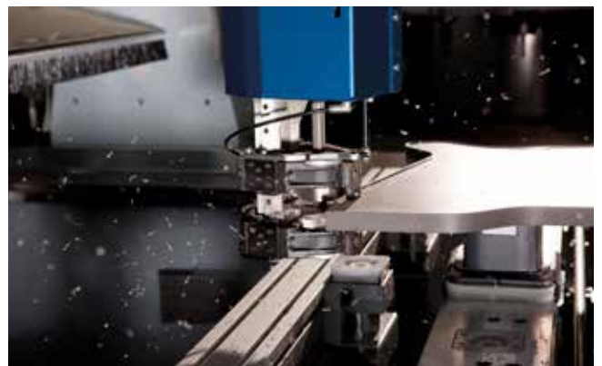
Chants d'une finition parfaite par un agrégat palpé combiné pour l'affleurage et le raclage
