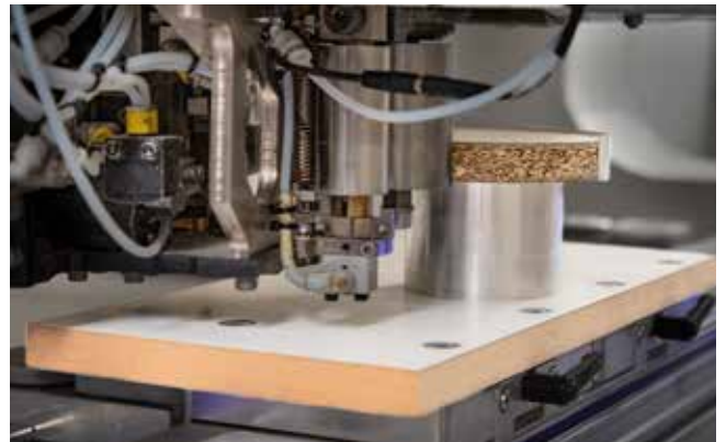
Collage de chant à 360° avec l'agrégat de placage powerEdge Pro Duo
