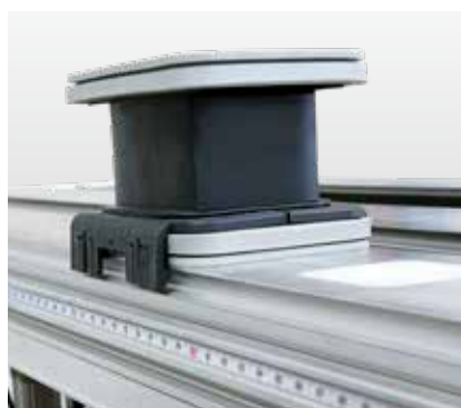
Mètre ruban pour le positionnement des ventouses.
