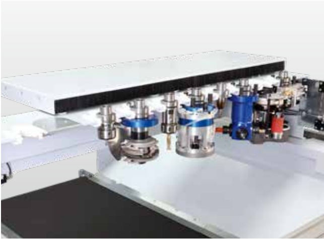
Changeur d'outils linéaire à 8 positions avec zone d'insertion d'outils, montage latéral. En option : intégration possible de la place pick-up pour l'agrégat easyEdge.
