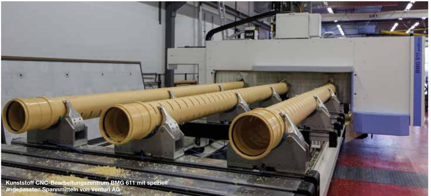
Kunststoff CNC-Bearbeitungszentrum BMG 611 mit speziell angepassten Spannmitteln von Venturi AG
