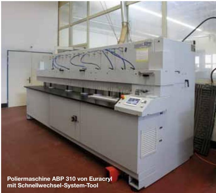
Poliermaschine ABP 310 von Euracryl mit Schnellwechsel-System-Tool
